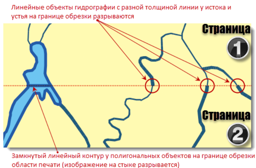
Рисунок 36. Результат интерпретации включённой опции «Клипировать объекты» программой формирования PostScript файлов
